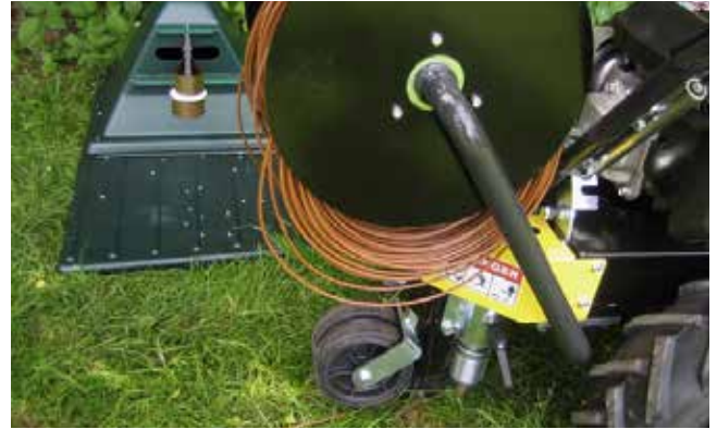
Maskine til nedlægning af ledning (OmTech Elektro)
